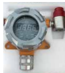
在线硫化氢气体监测仪，可在 电控柜及远程监控平台上有效 读取筒体内有毒气体含量， 给下井人员的安全增加保障
